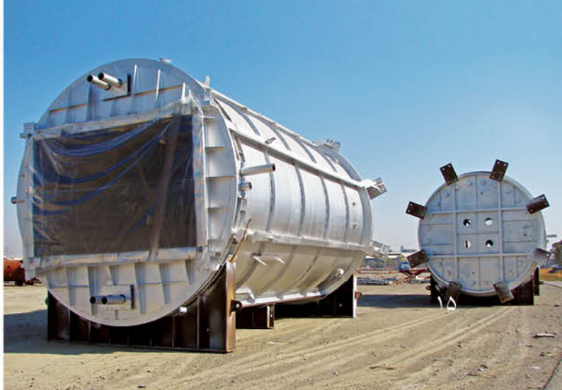
فایر هیتر پروژه اسکله صادراتی ماهشهر Maahshahr terminal revamp project fire heater
