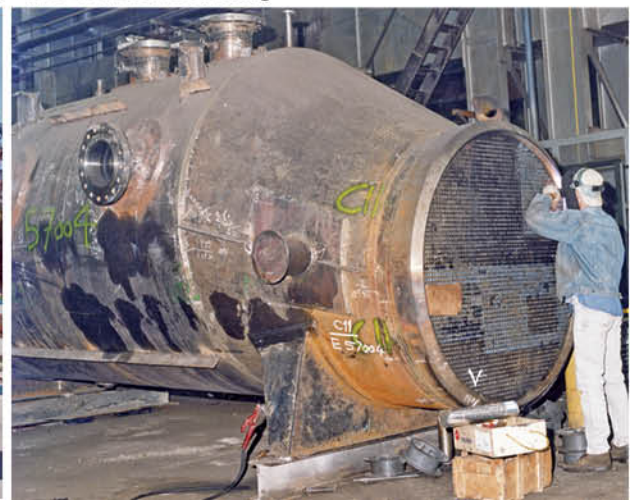
عملیات جوشکاری تیوب به تیوب شیت / مبدل حرارتی متانل به وزن ۸۰ تن Tube to tube sheet welding / Methanol heat exchanger, weight: 80 tons
